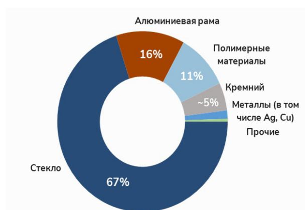
Рис. 4. Структура фотоэлектрической панели, в % от массы
