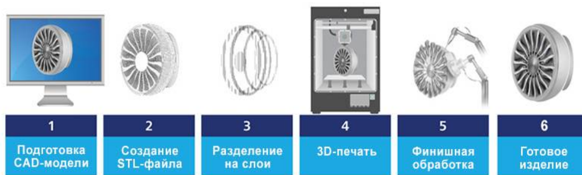
Рис.1 Последовательность аддитивного производства изделия.
